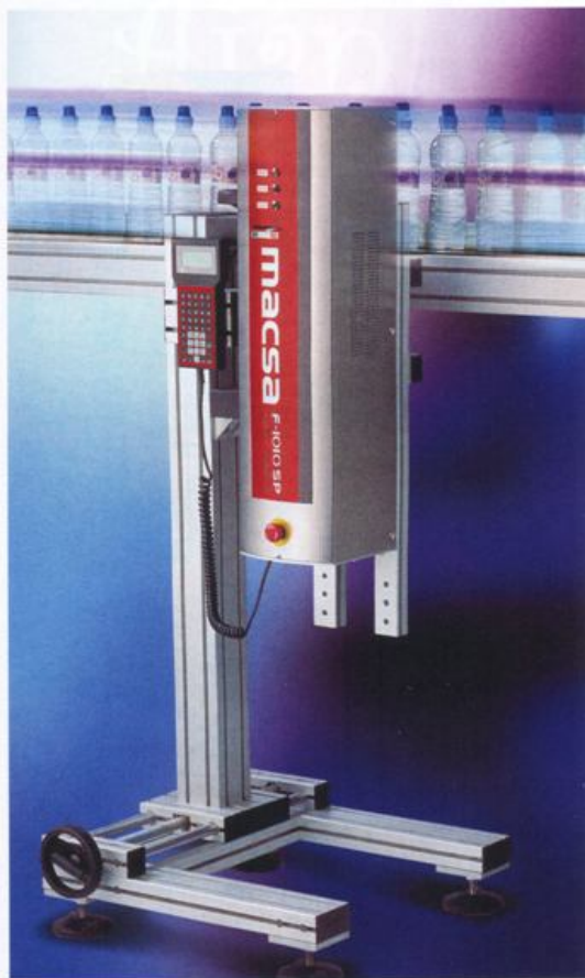
3. ábra: Műanyag palackok lézersugaras feliratozása
