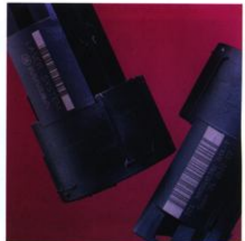
3. ábra: Műanyag alkatrészek feliratozása (műanyag elszínezése)
