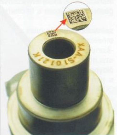
2. ábra: Járműalkatrész kódolása, 2D mátrixkód + szöveg (Nd:YAG lézer)
