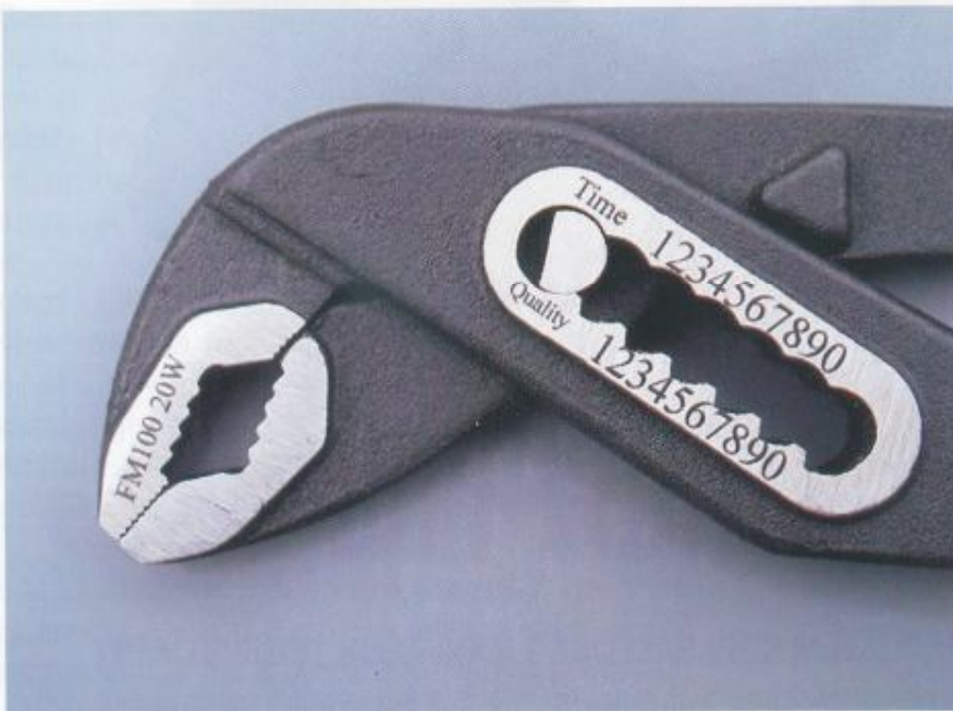
1. ábra: Fém szerszám jelölés (fiber lézer)
