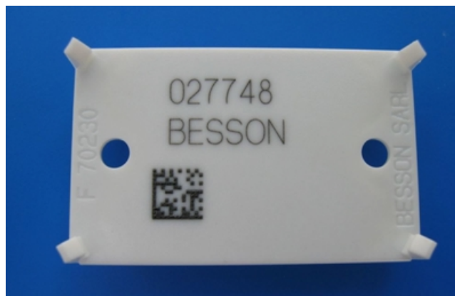
2. ábra: Azonosító kód műanyag alkatrészben
