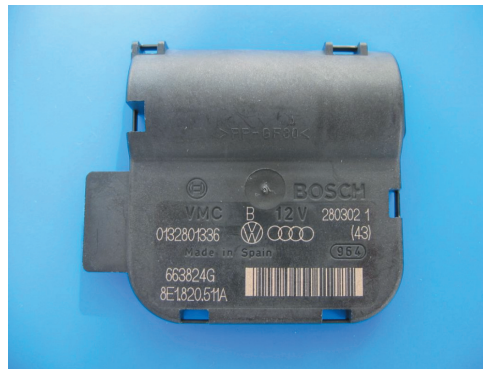
2. ábra: Műanyag alkatrészház jelölése FP-100 10W-os lézer berendezéssel
