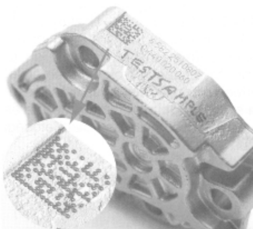
1. ábra: 2D termékazonosító (Dotmátrix) és adattartalom SpeedMarker FL lézergéppel)
